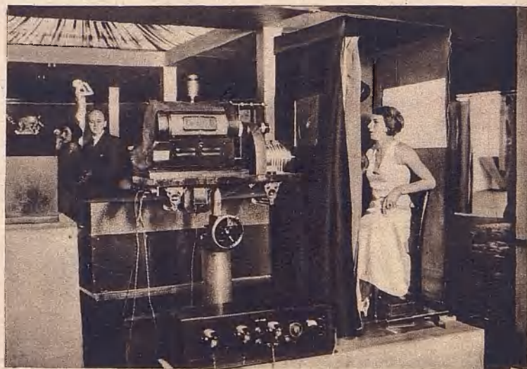
Aparat telewizyjny rozkłada obraz postaci „nadawanej” na poszczególne punkty.
