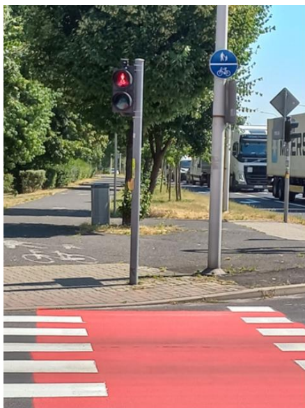
Fotografia 4. Sygnalizator usytuowany w świetle drogi rowerowej – Kalisz, skrzyżowanie al. Wojska Polskiego i ul. Serbinowskiej, 2022 rok
