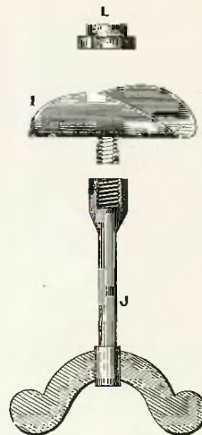
Le papillon (I), son écrou (L) et la clef de rallonge (J), dans la jante amovible.
