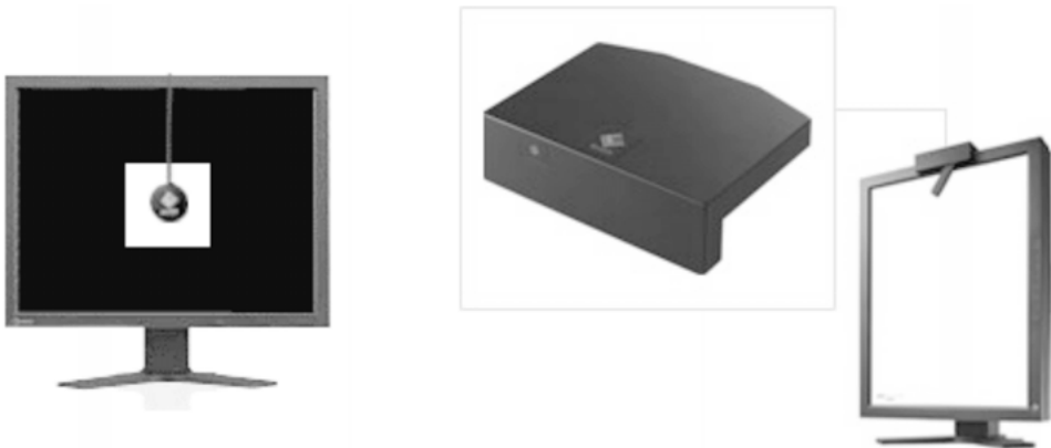
Rys. 8. Fotometry na ekranie monitorów w trakcie procesu kalibracji
