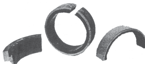
Rys. 4. Wycinki stalowej, gumowanej rury podsadzkiowej, którą w latach 1974–1986 przetransportowano w kopalni „Barbara-Chorzów” ponad 5 mln m 3 piasku podsadzkiowego z niewielkim dodatkiem kamienia
