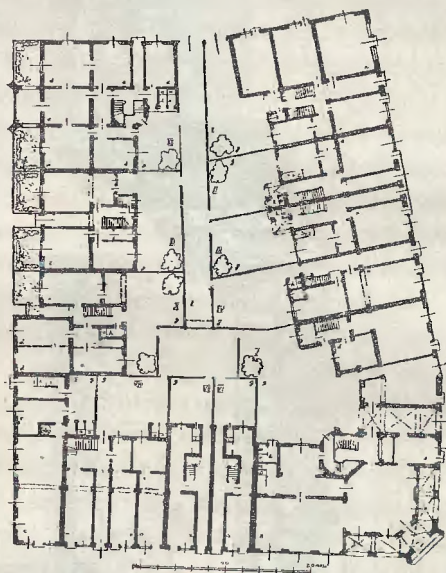
Ryc. 93. Zarys parteru domów całego bloku zwarto obudowanego w Puławach. W prawem narożu restauracja z podcieniami. Zresztą sklepy i warsztaty. Przy ogródkach mieszkania. Podwórza, po części zadrzewione, łączą się w jedną zdrową całość. Środkiem dojazd do podwórek.
