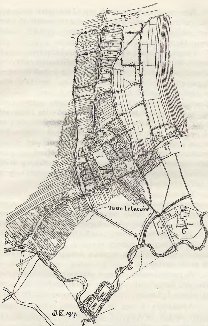
Ryc. 60. Zarys naturalnego odpływu wód powierzchniowych na terytorjum miasta Lubaczowa. Zarys ten może być pożyteczny dla pierwszej orientacji w sprawie projektu kanalizacji.
