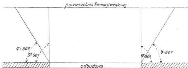
Rys 60. Kąty wpływów bezpośrednich \psi i pośrednich \varphi w wypadku poziomego uławicenie pokładu oraz w kierunkunkach rozciągłości przy nachylnym pokładzie
