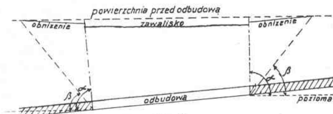
Rys. 1. Zwyczajne wpływy odbudowy górniczej \alpha - kąt zasięgu wpływów bezpośrednich \beta - " " " " pośrednich
