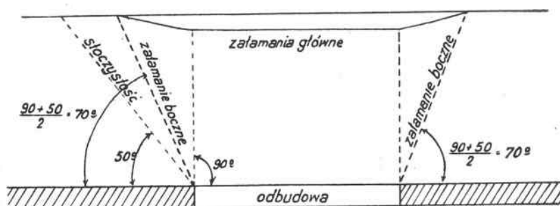
Rys 15. Skutki odbudowy według R. Hausse w kierunku rozciągłości pokładu
