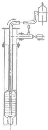
Pompa wyporowa Rys. 403
