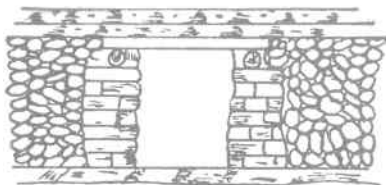
Obudowa z muru suchego ze stropnicami drewnianymi
