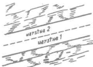
Wybieranie warstwami równoległymi do uławicenia Rys. 141
