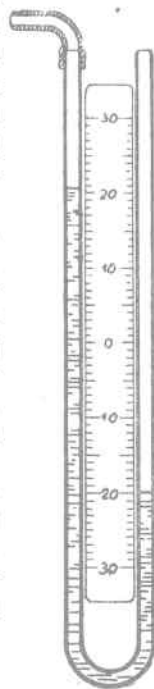
Manometr wodny Rys. 262
