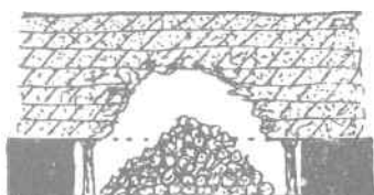
Zachowanie się stropu w skałach kruchych Rys. 211
