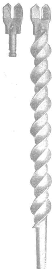
Wiertło spiralne z końcówką „Widia“ Rys. 170
