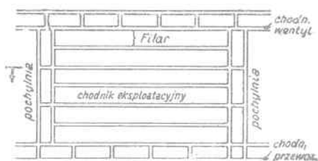
System filarowy podłużny
