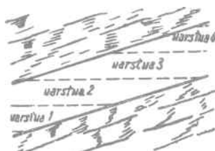
Wybieranie warstwami poziomymi Rys. 142
