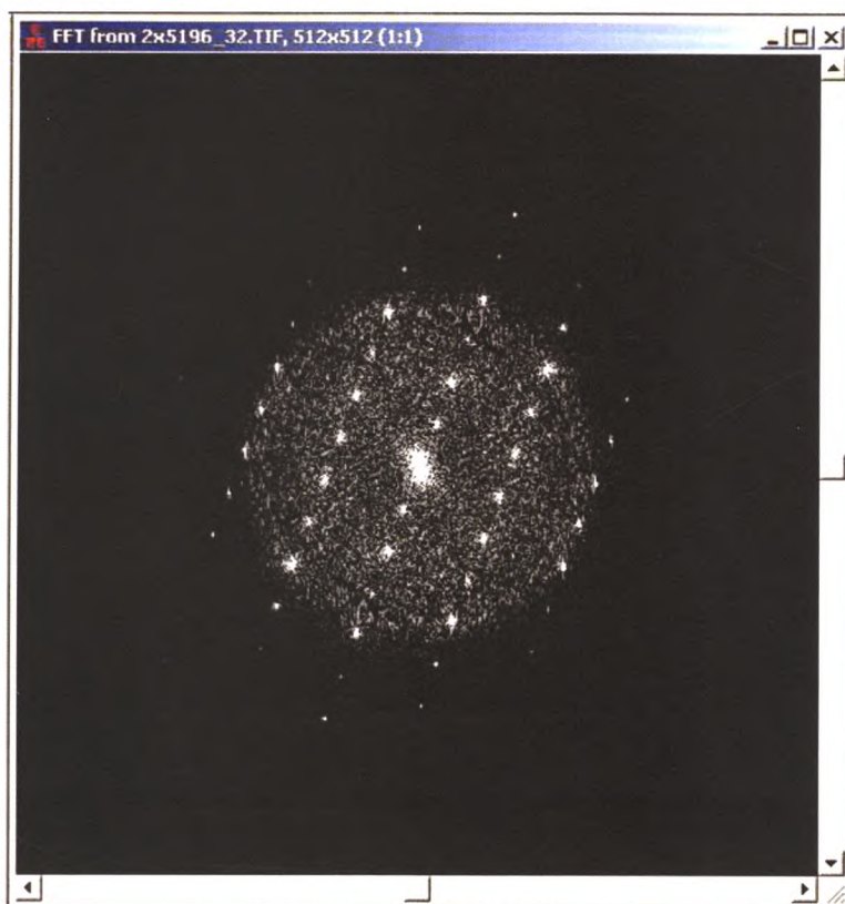
Rysunek 5.16. Transformata Fourier'a obliczona z obrazu wysokorozdzielczego (rys. 5.15)
