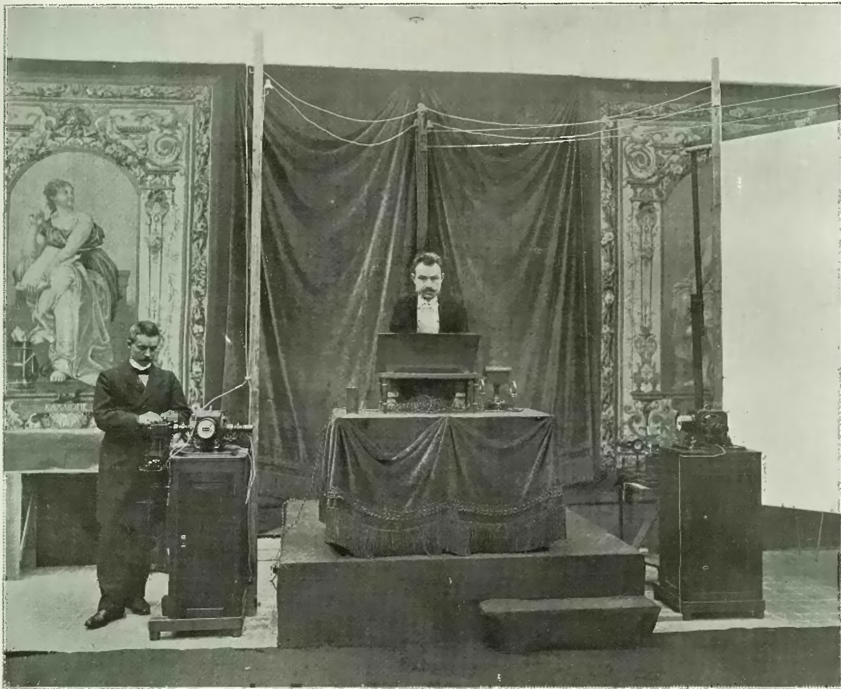
Poste transmetteur, avec les fils téléphoniques reliant ce poste à la ligne de Paris à Lyon.
