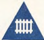
Przejazd kolejowy zabezpieczony (rampa)
