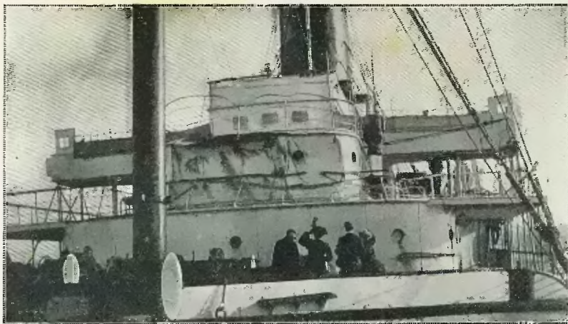
La passerelle du paquebot Provence , endommagée par un paquet de mer. Phot. comm. par M. Roelandts.
