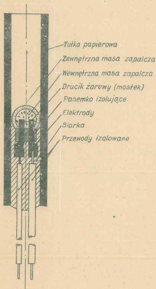
Rys.195. Zapalnik mostkowy
