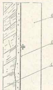
Rys. 180. Uszczelnienie obudowy betonowej wykładziną blaszaną
