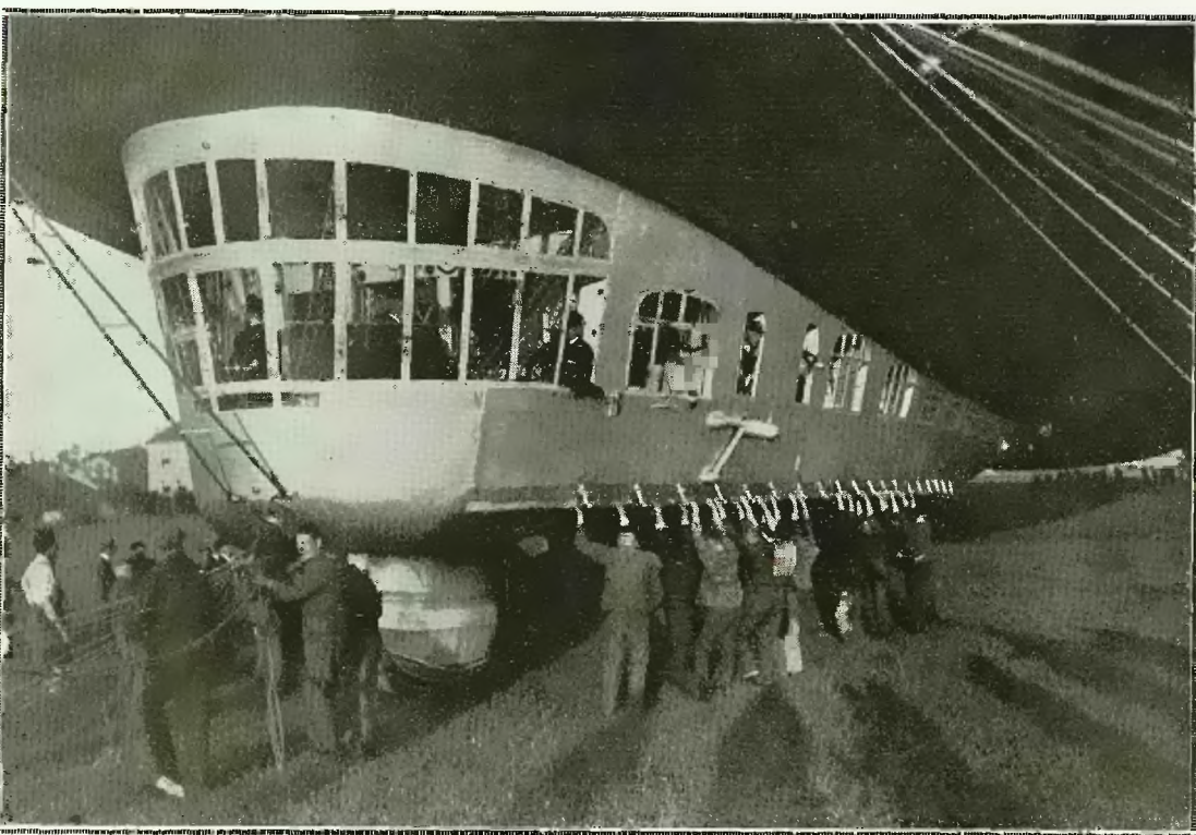
La nacelle principale du nouveau zeppelin, comprenant les postes de pilotage et les aménagements (salon, cabines, cuisine) pour les passagers. — Phot. Weyer.
