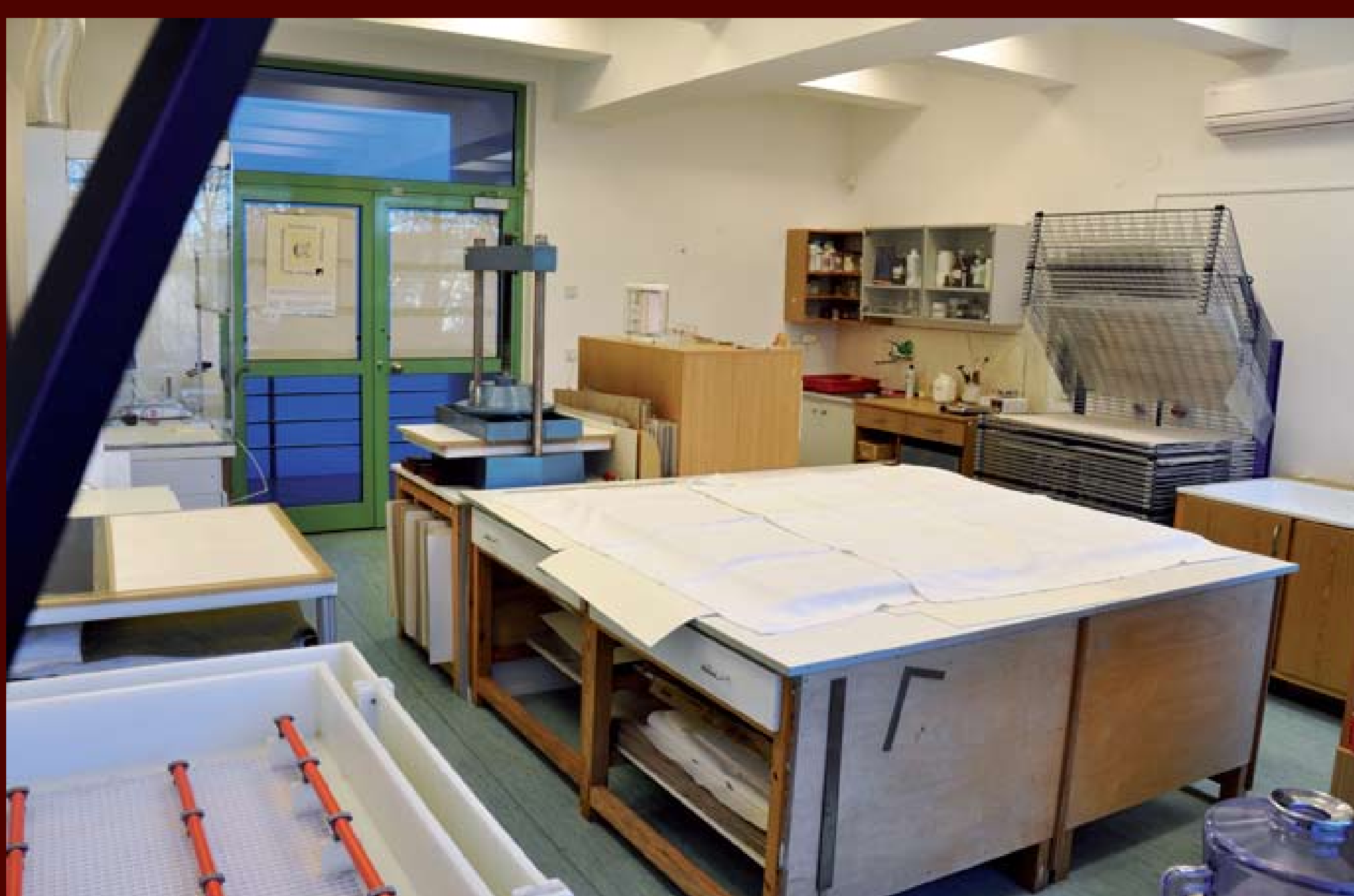
Pracownia konserwatorska „mokra”. W lewym, dolnym rogu widać maszynę do uzupełniania ubytków w kartach, w środku prasę introligatorską, po prawej stronie – nabytą w ramach projektu suszarkę ramową (jej zbliżenie po lewej).
