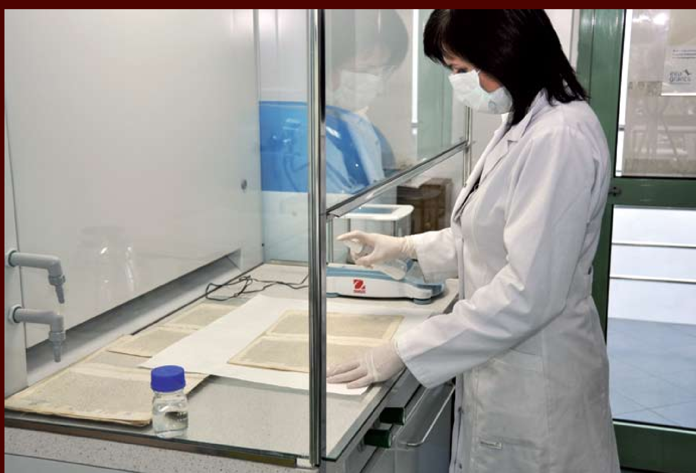
Wyposażone w efektywny wyciąg dygestorium umożliwia pracę ze stosowanymi w procesie konserwacji szkodliwymi dla zdrowia substancjami chemicznymi.
