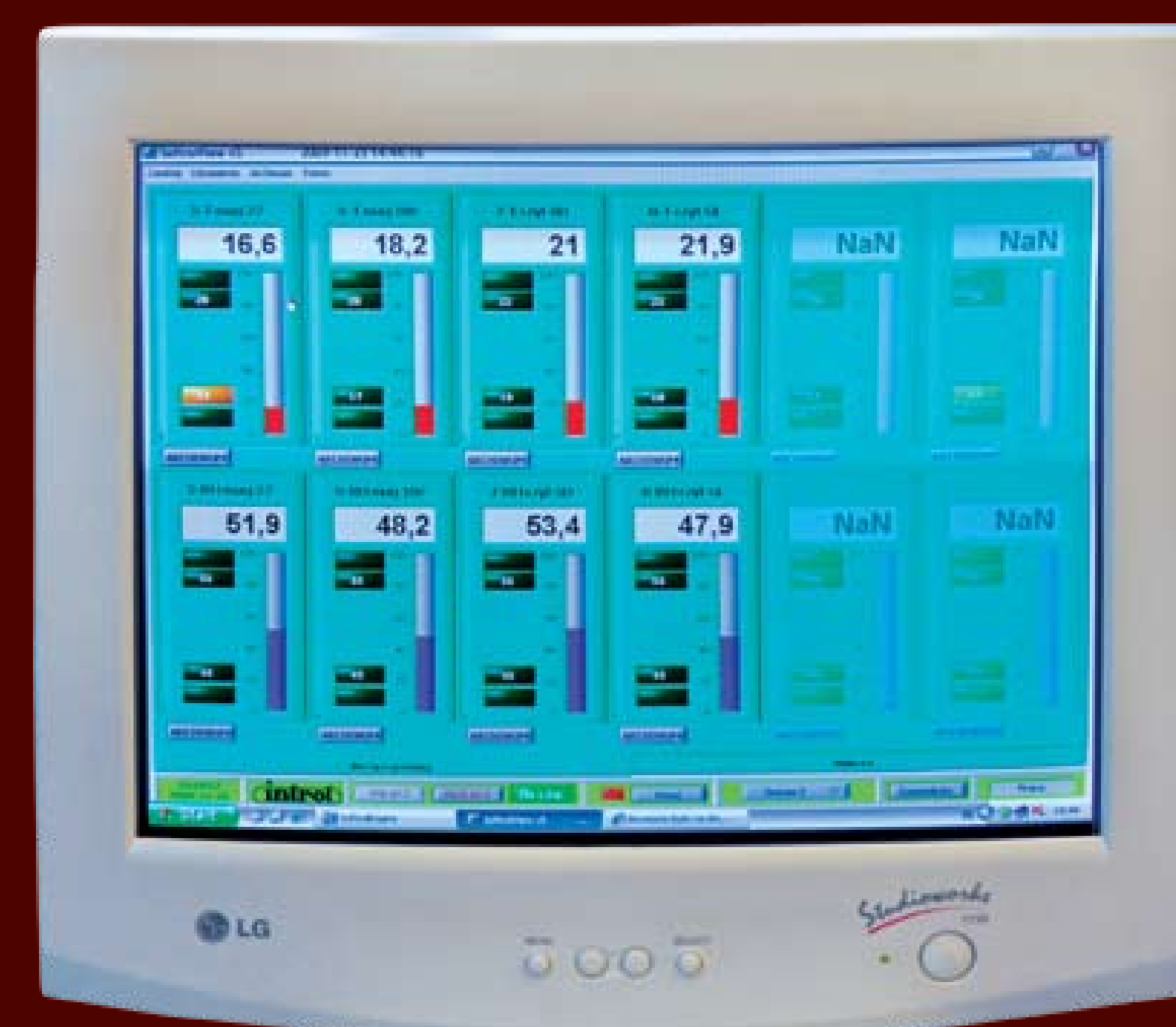
Urządzenia do kontroli warunków klimatycznych (na zdjęciach widoczne są termohigrograf oraz wizualizacja pomiarów pochodzących z zainstalowanego w Książnicy Cieszyńskiej elektronicznego systemu monitoringu temperatury i wilgotności powietrza).
