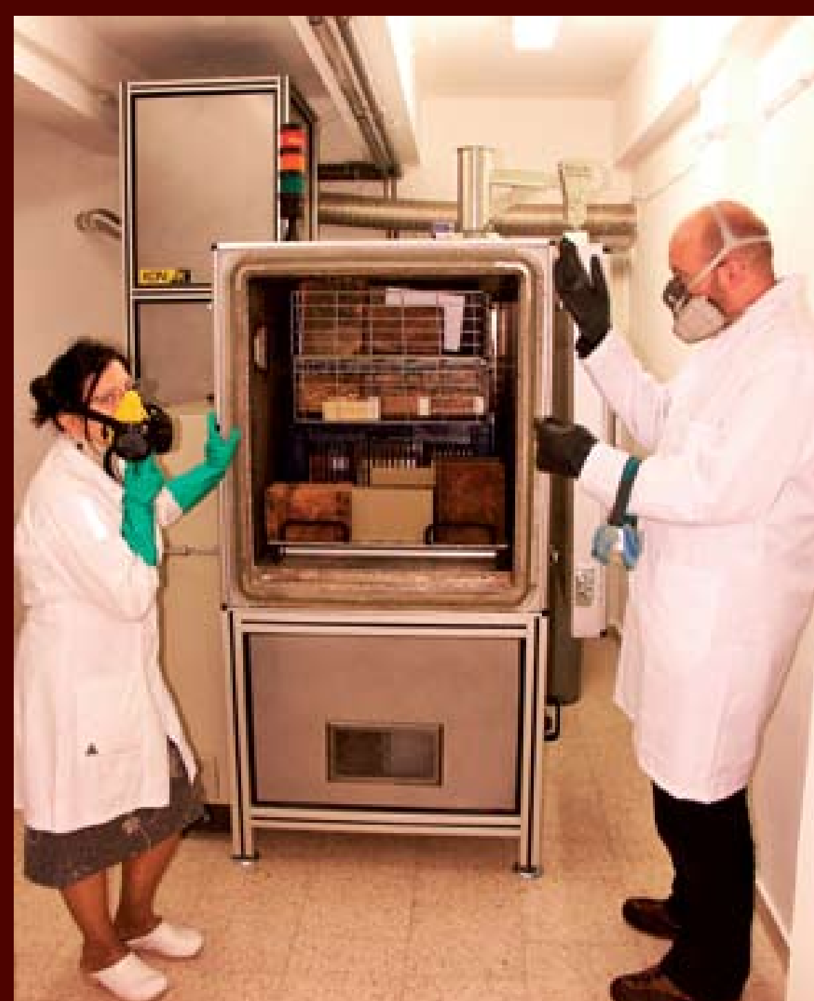
Nabyta przez Książnicę Cieszyńską nowa komora fumigacyjna pozwala na zdalne sterowanie procesem dezynfekcji.
