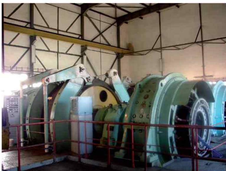
Maszyna wyciągowa szybu Aleksander III (przedział skipowy)
