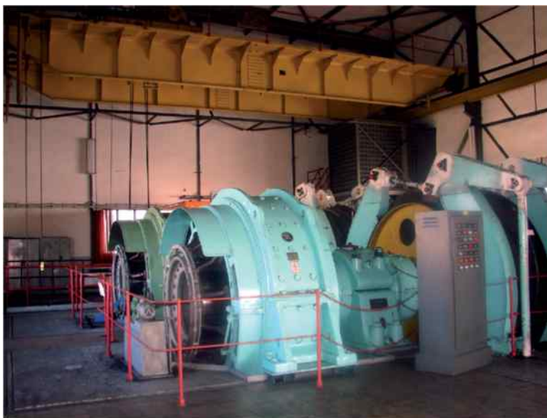
Maszyna wyciągowa szybu Aleksander III (przedział klatkowy)
