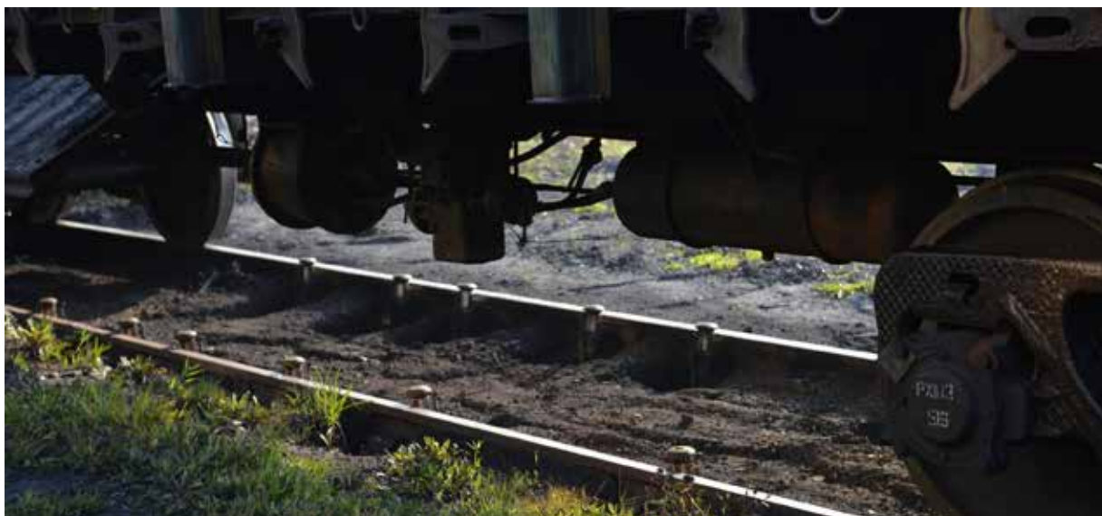
System hamulców tzw. „grzybków” zamontowanych w bazie przeładunku rud.
