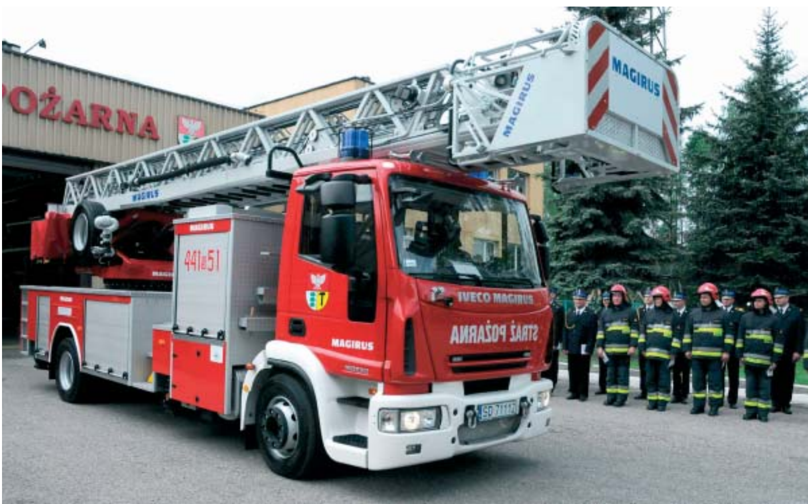
Stary podnośnik hydrauliczny potrzebował aż 10 minut na wysunięcie na rozłożenie wysięgnika. Nowa drabina wysuwana jest w niecałe 60 sekund.
