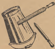
Rys. 5 Oczyszczanie blachy przed lutowaniem
