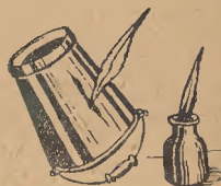
Rys. 6 Zwilżanie blachy „wodą do lutowania”
