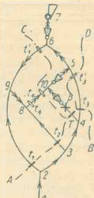
Rys. 98. Rozszerzenie strefy zabezpieczonej
