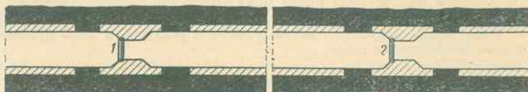
Rys. 19. Dwie tamy w omurowanej części chodnika czynne na przemian
