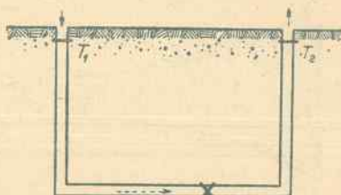
Rys. 132. Izolowanie pożaru przez zamknięcie całej kopalni
