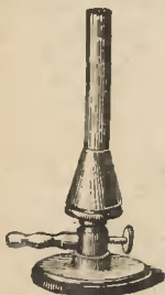
Rys. 37. Palnik Teelu. Rys. 38. Lampka do lutowania.
