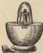
Rys. 35. Palnik spirytusowy.
