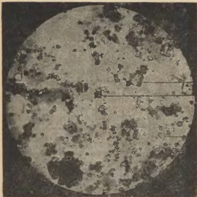
Rys. 67. Preparat szlifu sztucznego diamentu.
