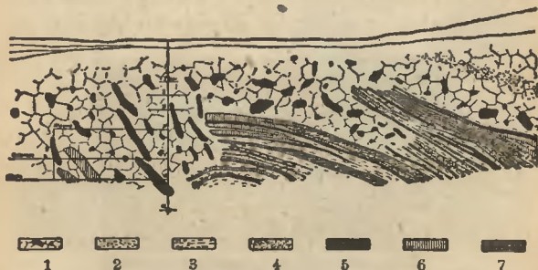
Rys. 72. Przekrój przez pokłady wielickie według prof. Niedźwiedzkiego: 1. ił solny; 2. margiel solny; 3. ił solny z anhidrytem; 4. piaskowiec solny; 5. sól zielona; 6. sól spiżowa; 7. sól szybikowa. — Poziome kreski oznaczają 7 pięter głównych, czyli poziomów.
