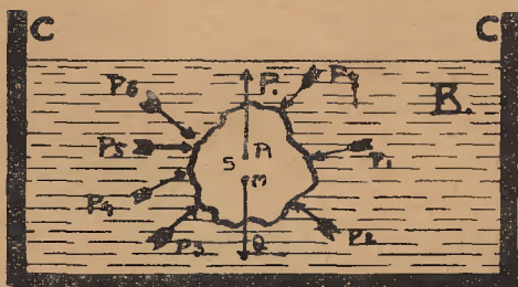
Rys. 5. Działania sił na ciało zanurzone w płynie. C naczynie; B płyn; A ciało zanurzone w płynie B ; M środek ciężkości ciała A ; P parcie; Q ciężar; p_1 p_2 \dots poszczególne parcia.
