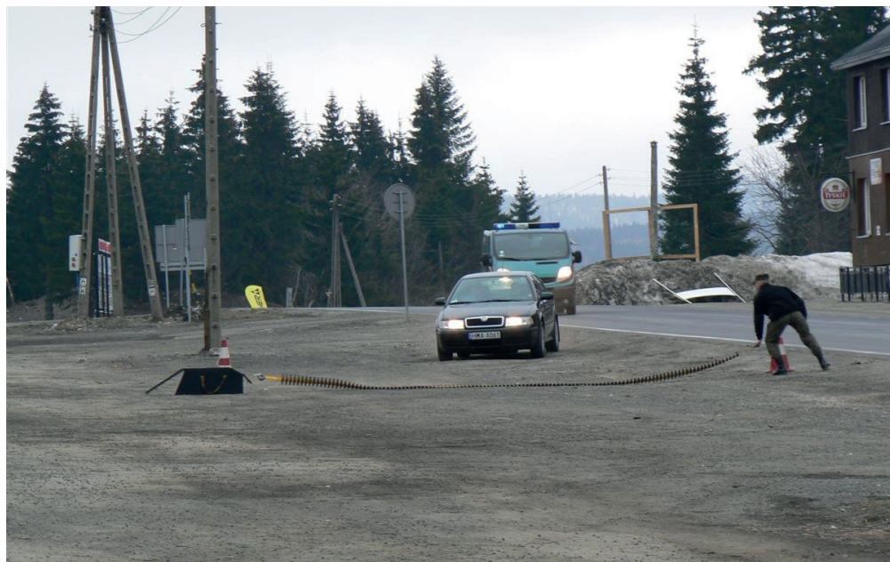
Fot. 2. Wykorzystanie kolczatki drogowej
