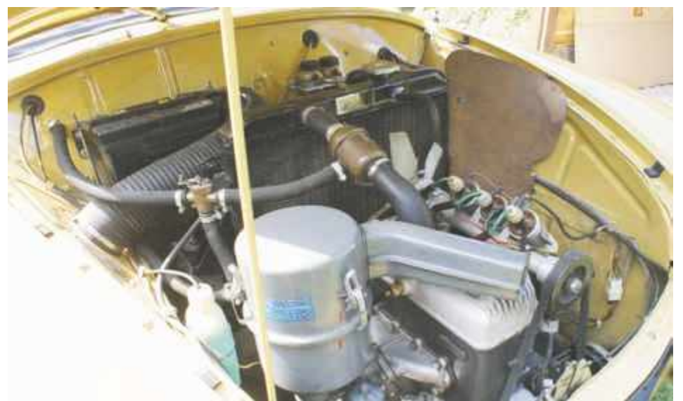
Trzycylindrowy dwusuwowy silnik o mocy 40 KM
