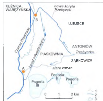
Przełożenie koryta Trzebyczki. 1 – pierwotny układ cieków, 2 – aktualny układ cieków, 3 – zbiorniki wodne, A – pierwotne ujście Trzebyczki do Przemszy, B – aktualne ujście
