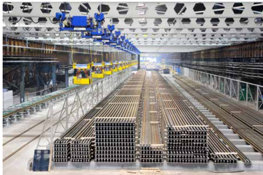
Oznakowane i gotowe szyny do wysyłki w dąbrowskiej walcowni dużej.
