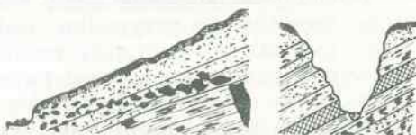
Rys. 27 (z lewej). Odlamki skał oznaka występowania złoża. Rys. 28 (z prawej). Naturalne odsłonięcie w terenie
