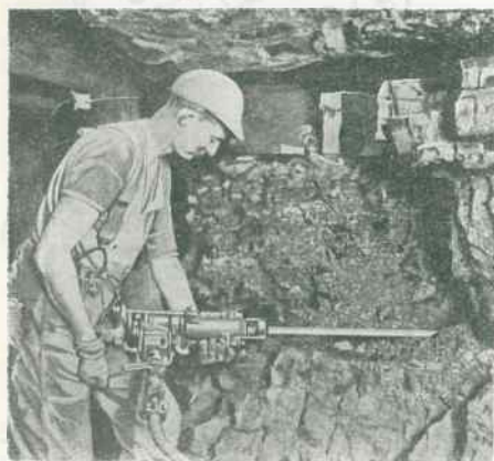
Rys. 118. Wiercenie otworu strzałowego wiertarką udarową z ręki
