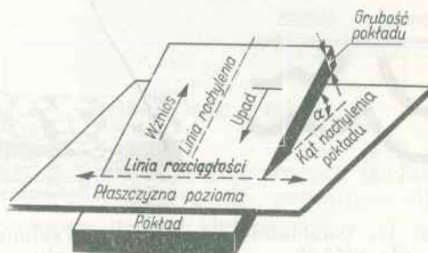
Rys. 15. Rozciągłość i nachylenie pokładu
