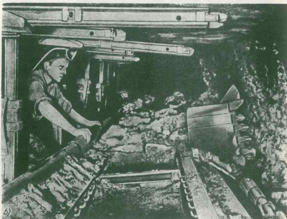
Rys. 222. Ścianowy kombajn strugający o nożach zębatych a — widok ogólny, b — podczas pracy w ścianie
