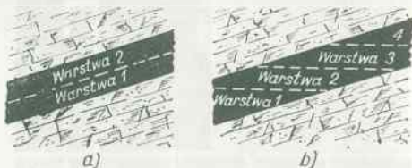
Rys. 193. Eksploatacja pokładu warstwami
