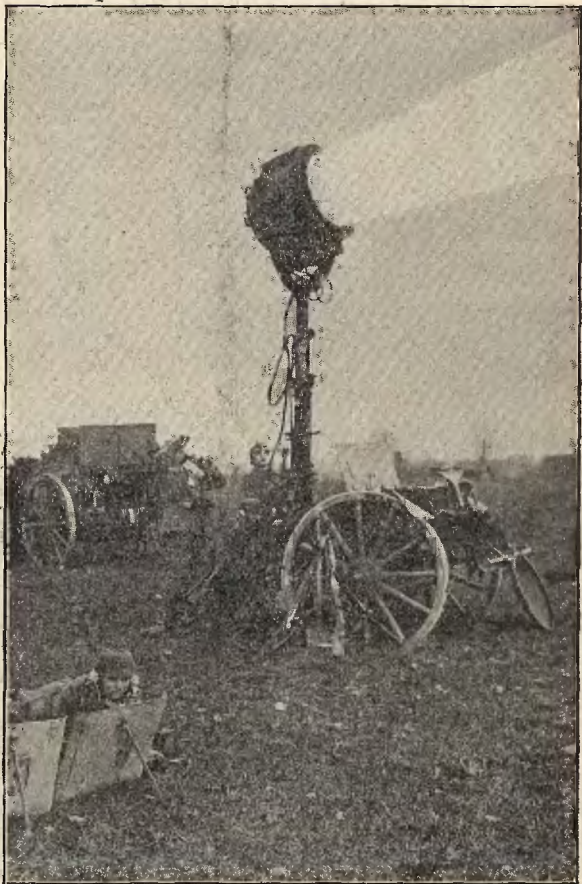
Reflektor poszukuje w chmurach nieprzyjacielskich statków napowietrznych; oficer na lewej stronie obserwuje ruchy samolotu nieprzyjacielskiego.
