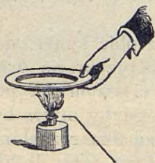
Fig. 38. Na talerzu tworzą się krople wody. Woda ta powstaje z połączenia wodoru, zawartego w spiritusie, z tlenem powietrza.
