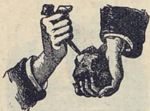
Fig. 4. Gwoździec żelazny rysuje kamień. Żelazo jest twardsze od kamienia.
