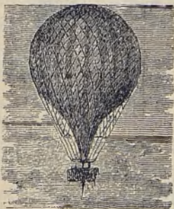
Fig. 36. Wodór, gaz nadzwyczaj lekki, jest bardzo dobry do napełniania balonów. Używają jednak na ten cel gazu oświetlającego, gdyż wodór kosztuje zbyt drogo.
