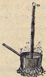
Fig. 22. Temperatura gotującej się wody jest nazwana temperaturą stustopniową ( 100^{\circ} ).
