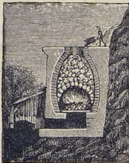
Fig. 6. Przekrój pieca, służącego do wypalania wapna. Wapnienie nagrzane silnie, przemieniają się w wapno niegaszone.
