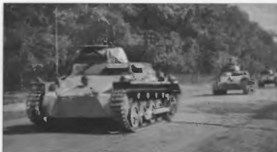
Lekkie czołgi Pz.Kw I Ausf B. Uzbrojenie: 2 km-y kalibru 7,9 mm, masa 6 t., załoga 2 osoby. Podstawowe wyposażenie 5. DPanc.
