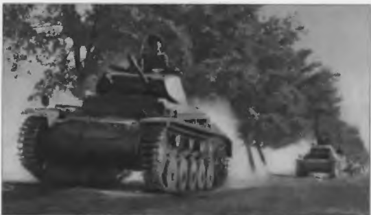
Lekkie czołgi Pz.Kw II Ausf B. Uzbrojenie: armata 20 mm, km kalibru 7,9 mm, masa 7,9 t., załoga 3 osoby. Podstawowe wyposażenie 5. DPanc.
