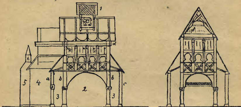
Längsdurchſchnitt einer vierſäuligen Stabkirche (Lomen) mit Dachreiter (Hurnum) aber ohne Lauſgang.
