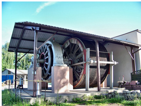
77. Maszyna wyciągowa Siemens-Schuckert szybu „Powietrznego III” pod zadaszeniem.
