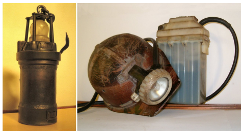
16. Lampy; przenośna R-21/49, nahełmowa RC-12.
