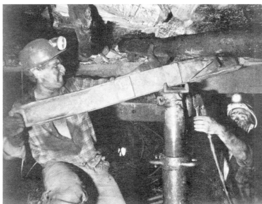
31. Zabezpieczanie stropu przy pomocy stojaka SHC.
