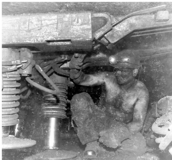
33. Przesuwanie sekcji obudowy MK-97.
