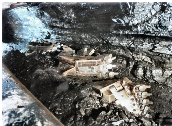
72. Strug firmy Halbach-Braun.
