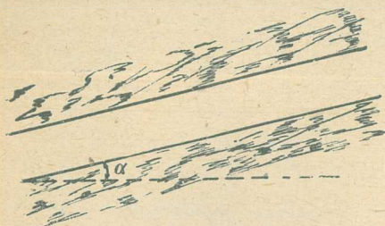
Rys. 42. Chodnik prowadzony równoległe do uławicenia
