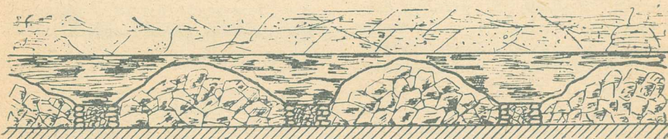
Rys. 50. Częściowy zawal stropu przy wykorzystaniu dla podsadzki skały z zawalu
