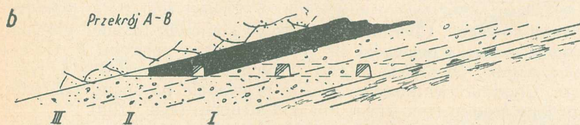
Rys. 215. Przykład wybierania pokładu na trzy warstwy
