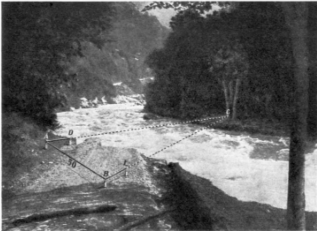
Rys. 30. Wymierzanie odległości punktu niedostępnego.
