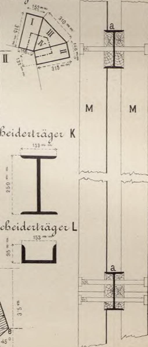
Fig. 11. Spurlattenverbindung am Schachtblosse.
