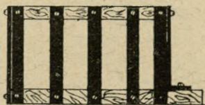
Rys. 20. Umocowanie podstawy silnika do podstawy hamulca.
