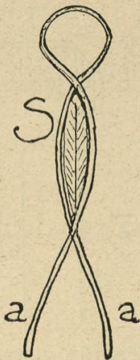
Rys. 6. Sposób zgięcia sprężyny S zastępującej kurek.
