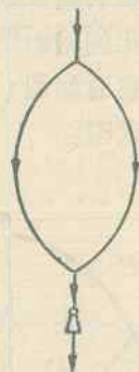
图 108 下行风流通风的风流结构图
