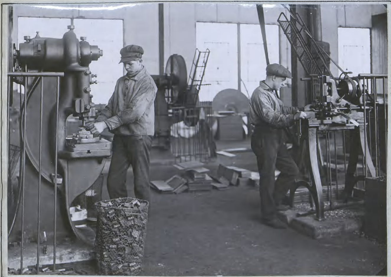
IMW - PIŁARNIA: Wycinarka uszek do pił i uzębiarka.
