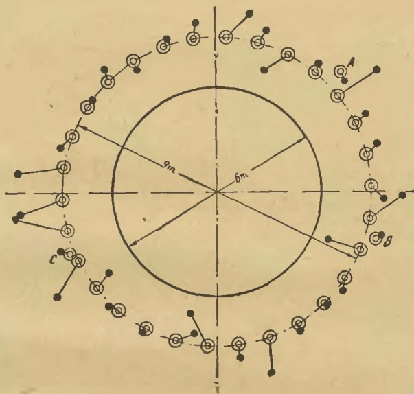
Abb. 16. Anordnung der Bohrlöcher eines Gefrierschachtes. Nach Riemer: Schachtabteufen.
