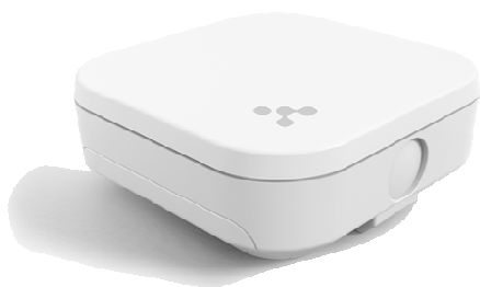
Rys. 4. Brama dostępowo-integrująca Gateway do obsługi infrastruktury Kontakt.io
