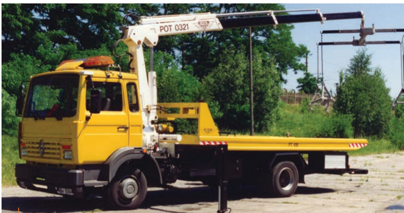
Żuraw przenośny POT 0321 przeznaczony do prac załadunkowych, ratownictwa technicznego i pomocy drogowej, lata 90. XX w.
