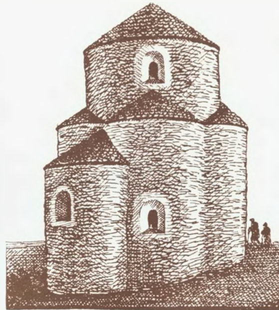
Rotunda Najśw. Marji Panny na Wawelu (później św. Feliksa i Adaukta) z X wieku, według wzorów włoskich: 1) rekonstrukcja, 2) mur i okno z płasko łupanych kamieni.
