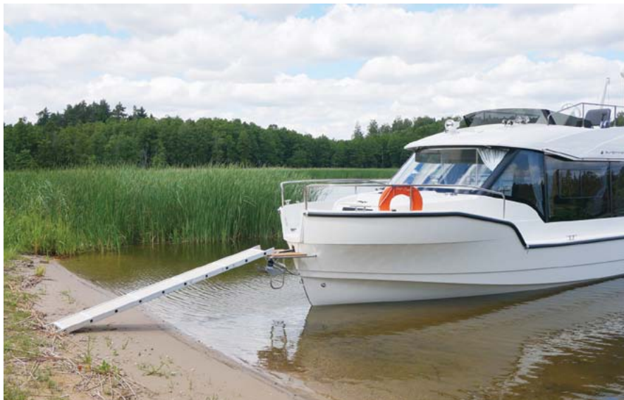
Inny egzemplarz łodzi wyposażono dodatkowo w dziobowy stopień i trap.
