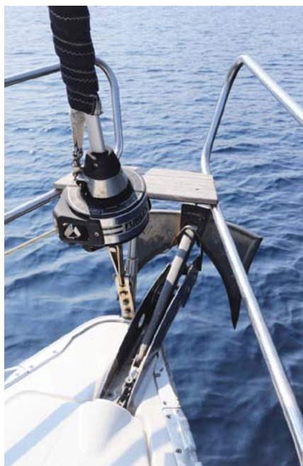
Kotwica Jambo-Anker z dużymi ostrymi zębami.
