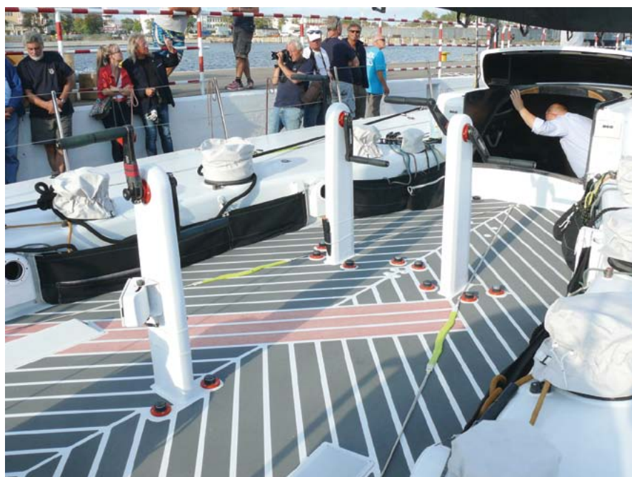
Kabestany młynkowe ułatwiają obsługę lin.
