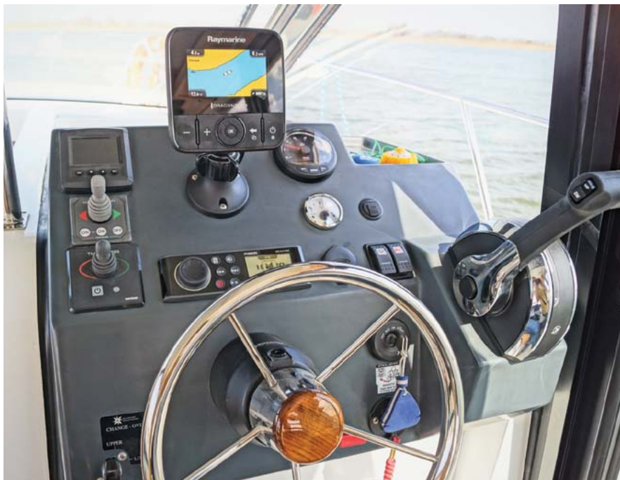
Na pulpicie mamy między innymi joysticki sterów strumieniowych, ploter, radio, manetkę i zegar silnika.
