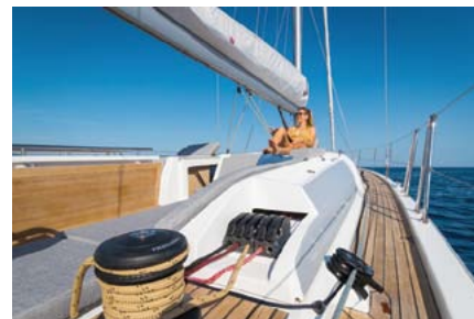
Liny poprowadzono w pokładowych tunelach.
