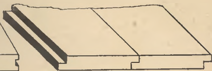
Rys. 100. Wiązanie w zakładkę.
