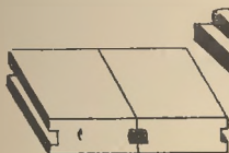
Rys. 99. Spojenie na falszywy wpust.
