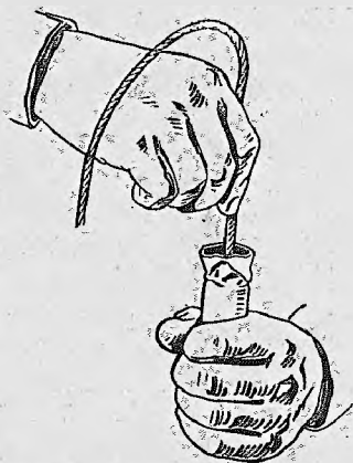
Abb. 61. Die Sprengkapsel wird in die Schlagpatrone eingeführt
