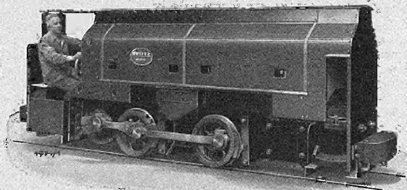
Abb. 115. 10 t Deutz-Diesel-Grubenlokomotive für Hauptstreckenförderung. (Wertphoto: Humboldt-Deutzmotoren A.G.).
