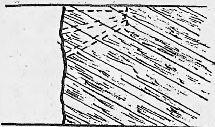
Abb. 86. Einbruch bei zufallenden Gebirgsschichten
