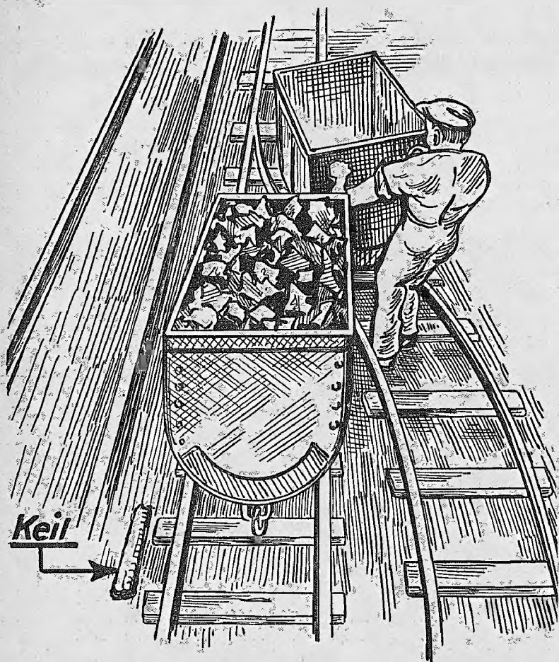
Abb. 18. Bei seitlicher Verschiebung des Wagens wäre der Unfall vermieden worden
