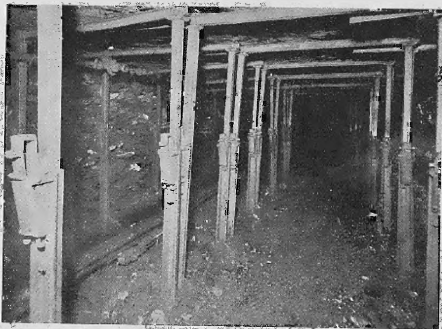
Abb. 38. Strebau aus Toussaint-Heinemann-Stahlstempel unter Verwendung von Schienen am Hangenden
